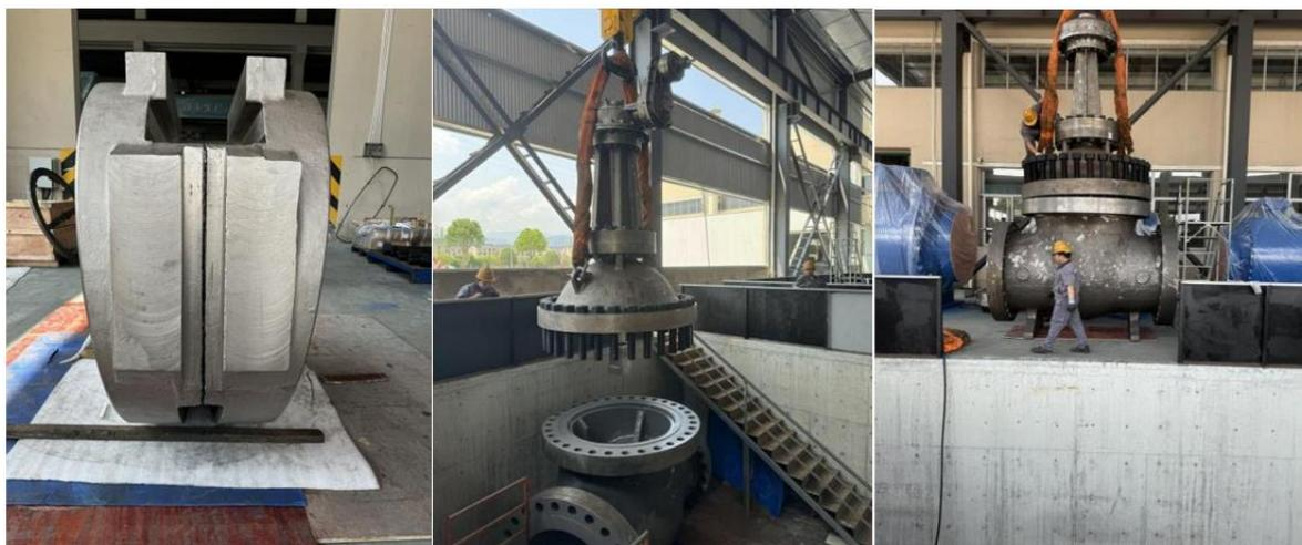
图 3 48"-Class900 楔式闸阀组装制造
